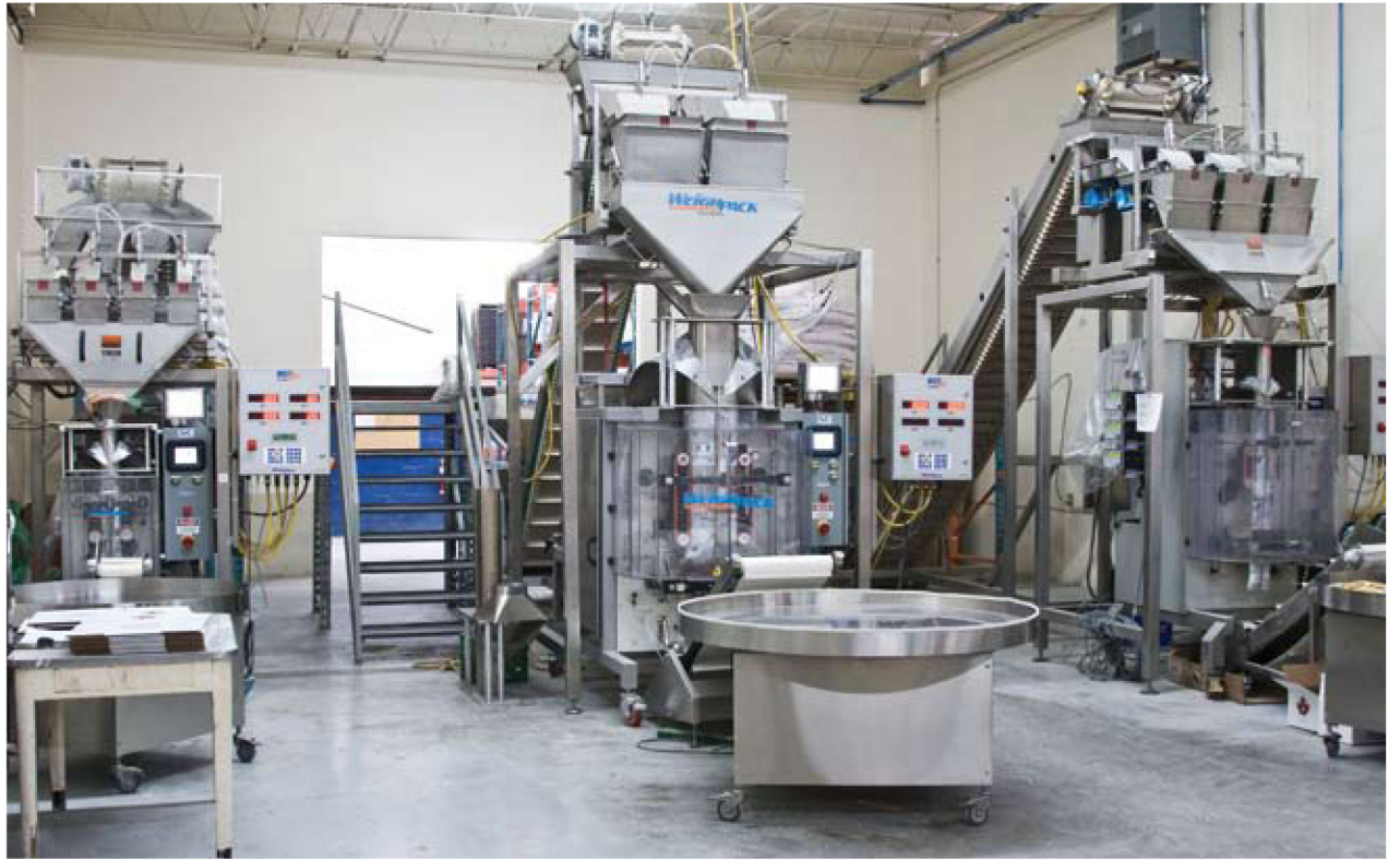
Au centre, l'ensacheuse verticale automatique WeighPack sur laquelle sont conditionnés les sacs de 10 kg.
