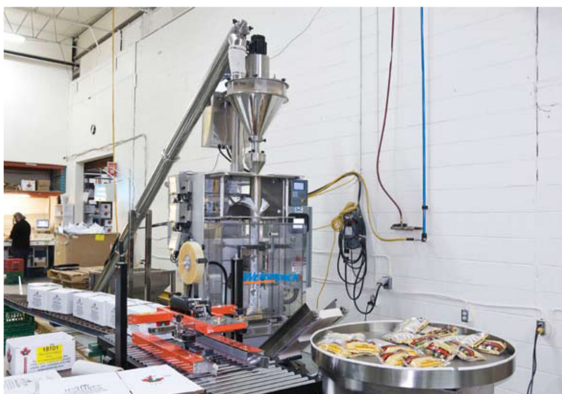
Une des quatre ensacheuses automatiques WeighPack utilisées par Clic International.
