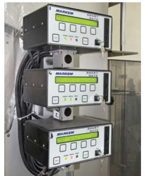
Les codeurs à date Markem. Image d'une des quatre ensacheuses verticales qu'utilise Clic International.
