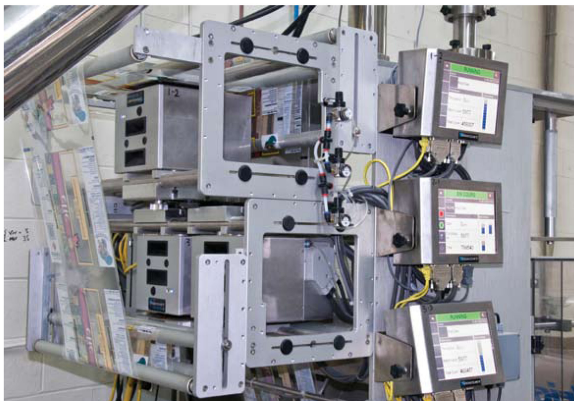
Panneaux de contrôle d'imprimantes Videojet.
